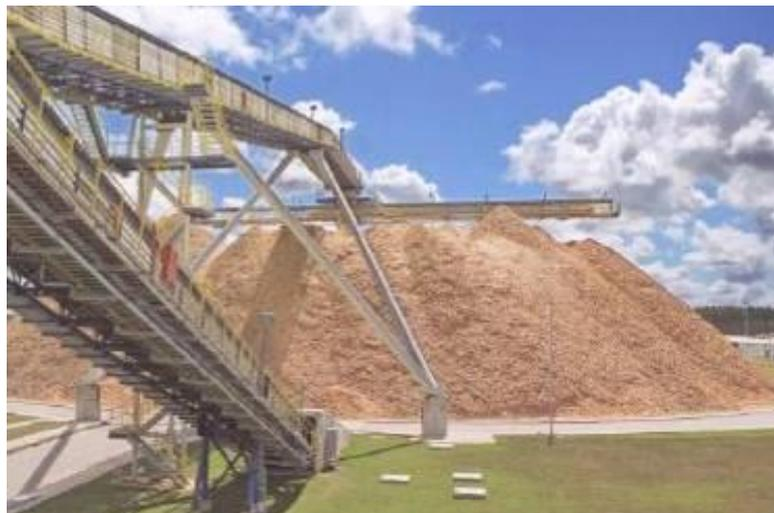
**Figura 2.3.5.1-2. Pilha de cavacos.**
