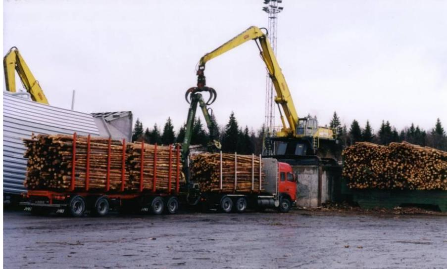
**Figura 2.3.5.1-1. Descarregamento das toras de eucalipto no pátio de madeira.**
