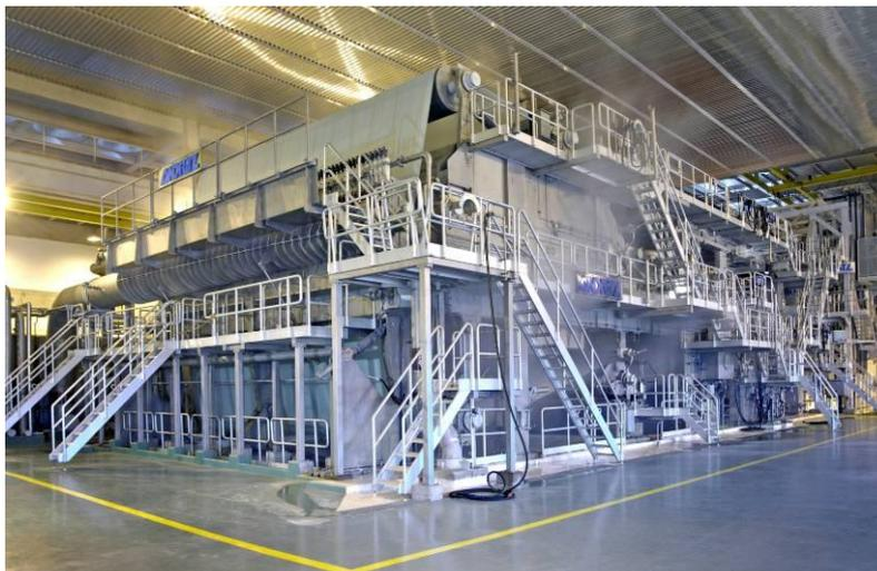
**Figura 2.3.5.1-5. Máquina de secagem de celulose.**
