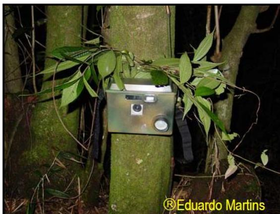
**Figura 7.12.3-3: Armadilha fotográfica instalada para registro da mastofauna.**
