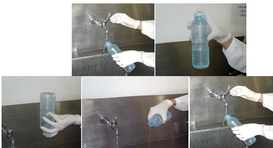
Figura 06. Procedimento de coleta de água para a análise físico-química
