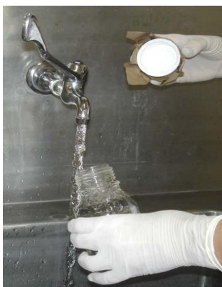
Figura 04. Coleta de água para a análise microbiológica.
