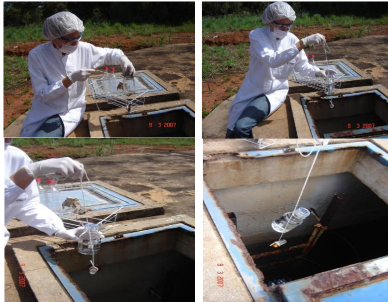
Figura 08. Procedimento de coleta em poços para análise microbiológica.
