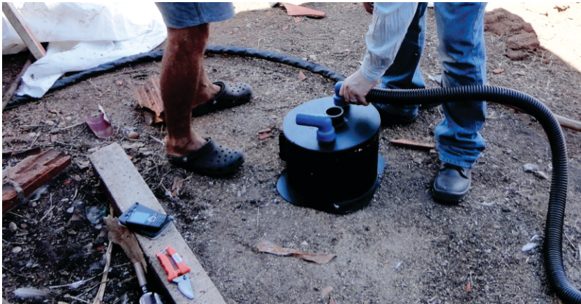
Figura 21 – A válvula de escape tem a função de liberar o gás quando a pressão no interior do biodigestor atinge a pressão máxima suportada pelo biodigestor.
