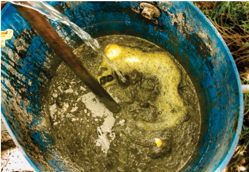
Figura 23 – A mistura bem feita do esterco com água é fundamental para o bom funcionamento do biodigestor. Para essa operação, coloque o esterco fresco na caixa de entrada, acrescente a quantidade de água necessária e, depois, misture até que fique bem homogêneo.
