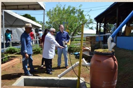
Sistema de Pré-Tratamento de Água – Sistema interligado a uma calha coletora de água de chuva de um telhado com chuva artificial produzida em circuito fechado
