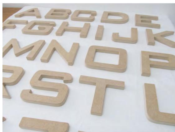
Figura 3 Letras cortadas à laser em MDF. Fonte:
