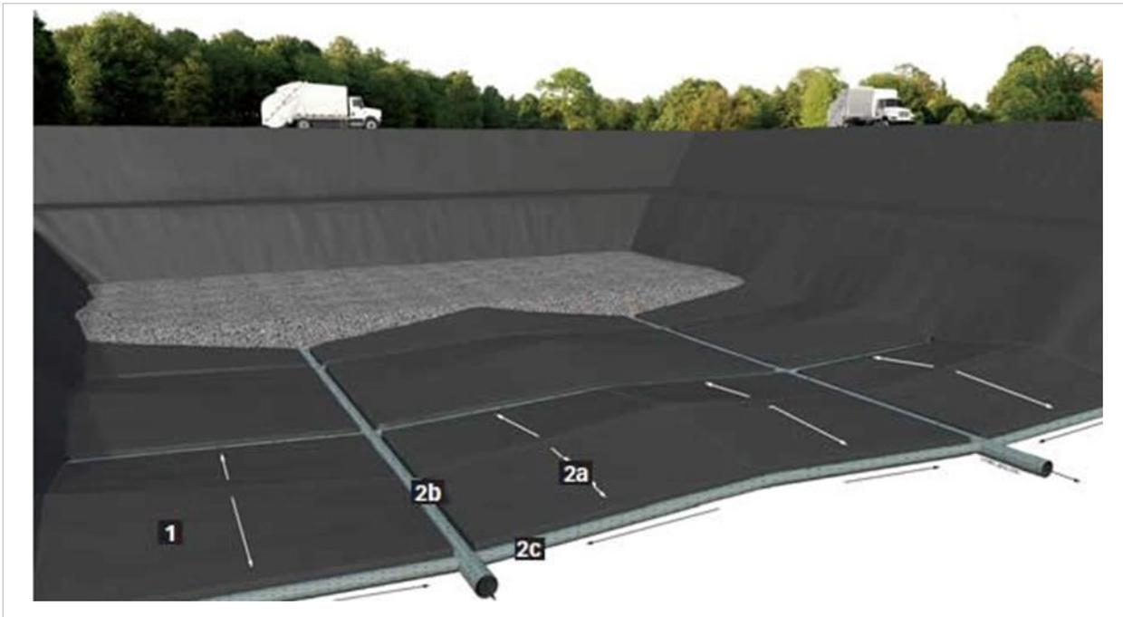
1. Base do aterro compactada sobre a qual se instala a geomembrana.
