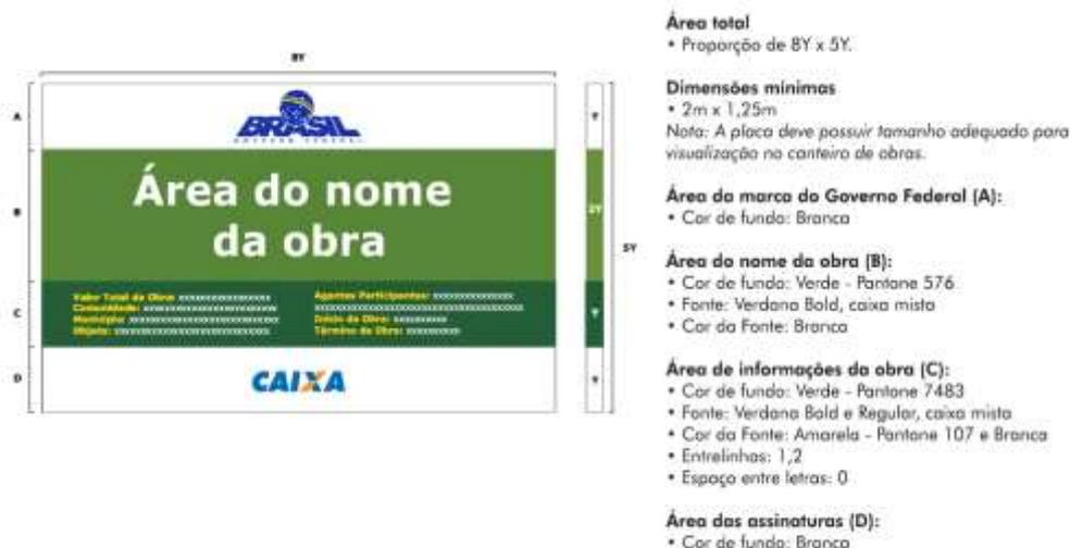
Figura 1 - Modelo para Placa de Obra.
