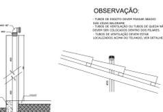
DET. COLUNA DE VENTILAÇÃO
