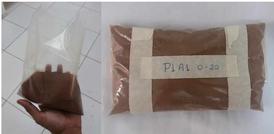
FIGURA 31. Armazenamento e identificação de amostra composta. P1 = propriedade 1; A1 = área 1; 0-20 = profundidade da camada coletada - 0-20 cm.
