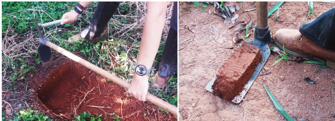
FIGURA 36. Introdução do enxadão na parede da mini-trincheira e amostra coletada após o descarte do solo das extremidades do enxadão.
