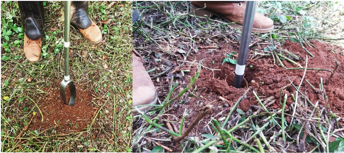
FIGURA 34. Limpeza da superfície de coleta e introdução do trado até a marcação do limite de profundidade.
