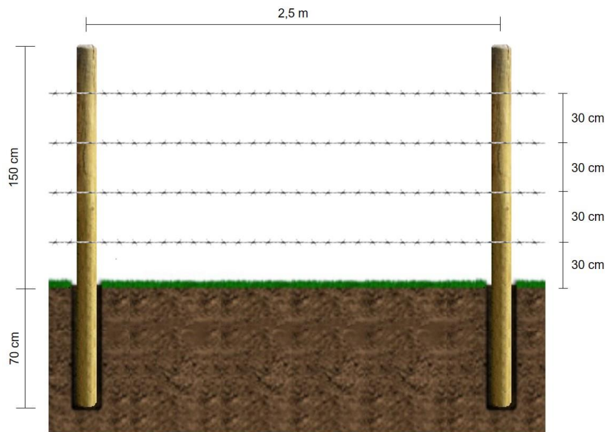
FIGURA 16. Esquema para construção de cerca para isolamento contra a entrada de animais de grande porte.
