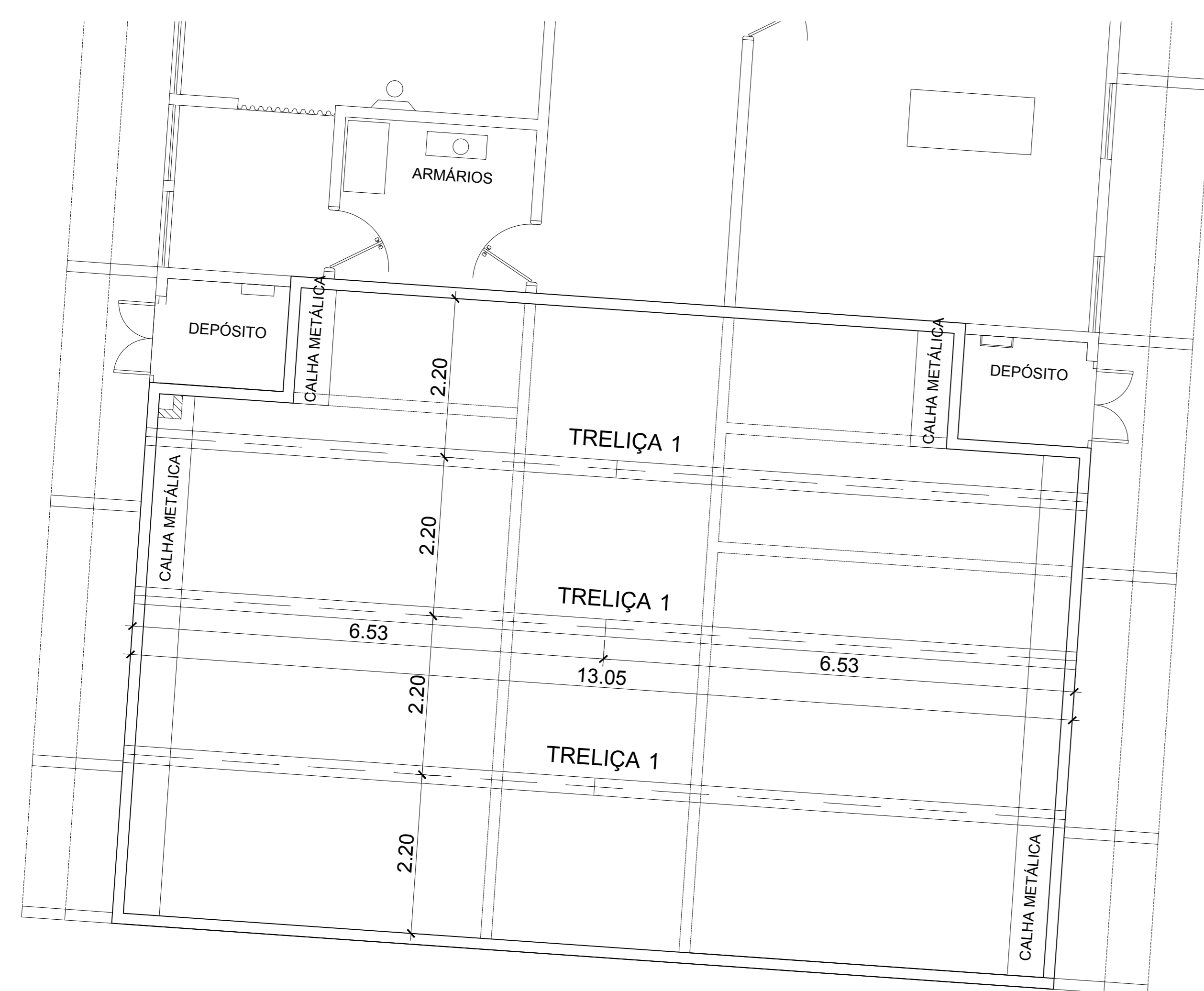
PLANTA DE COBERTURA - TESOURAS Escala 1: 50
