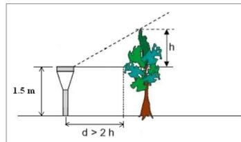
Figura 1: Esquema de posicionamento do pluviômetro em relação aos obstáculos.
