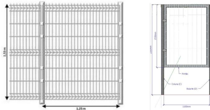
Desenho esquemático dos postes e painéis metálicos e esquemático do portal (portão, coluna e batente)
