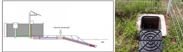
Tipo de caixa de manutenção e Ponto de instalação
