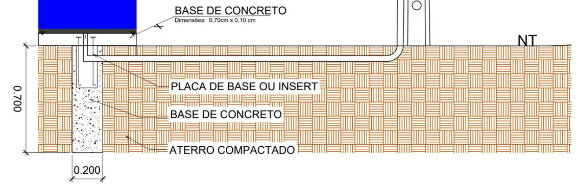
DETALHAMENTO DE INSTALAÇÃO DO TOTEM
