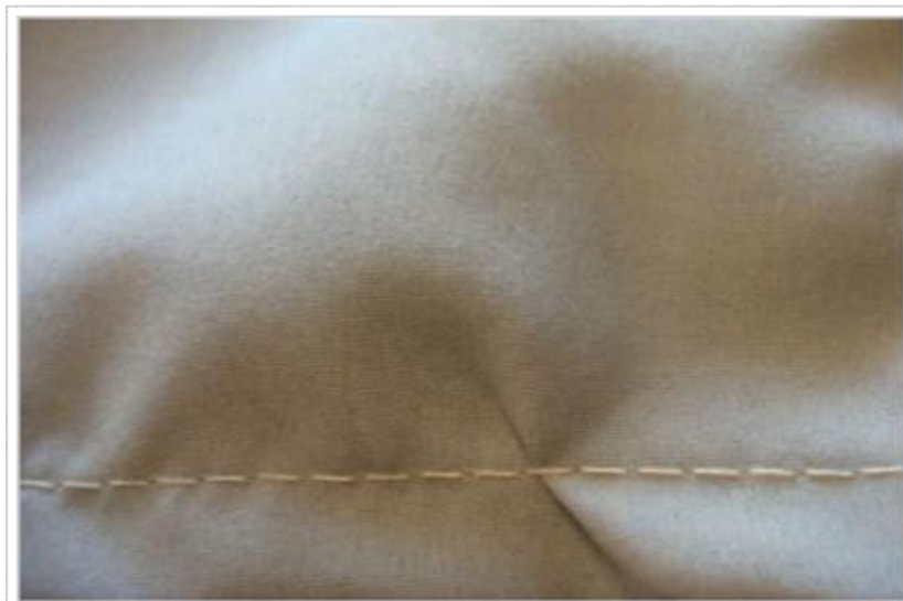
Figura 20 - Peça com costura com pregas
