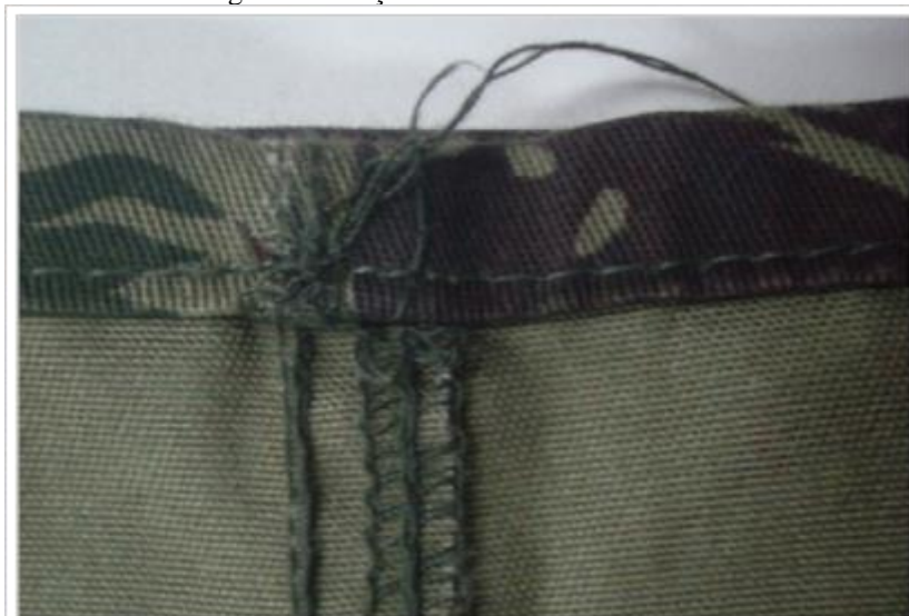
Figura 23 - Peça com defeito de acabamento
