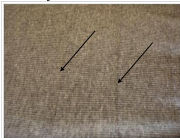
Figura 1 - Tecido com barramento
