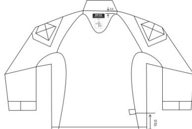
Figura 6 - Detalhes internos das costas e localização das etiquetas
