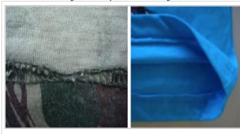
Figura 17 - Peça com bainha irregular
