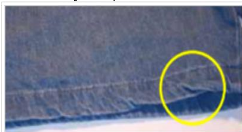
Figura 18 - Peça com bainha torcida
