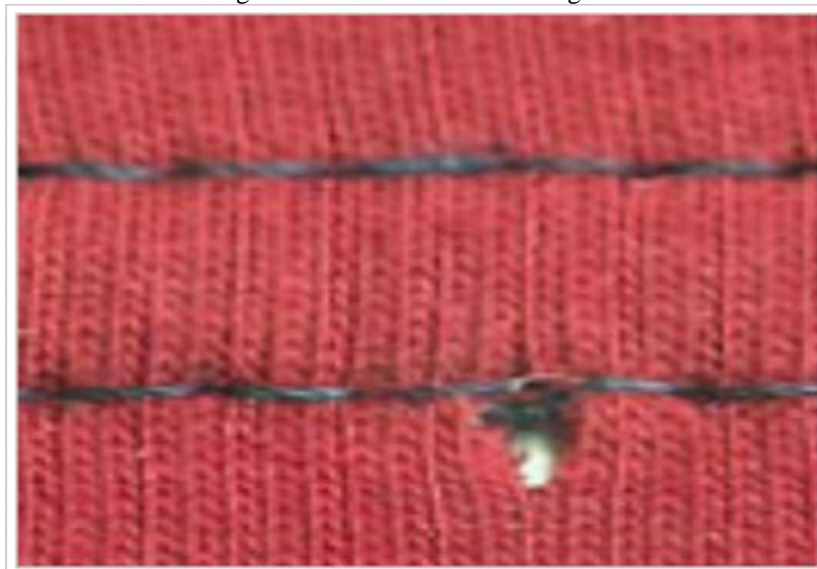
Figura 11 - Tecido com furo de agulha
