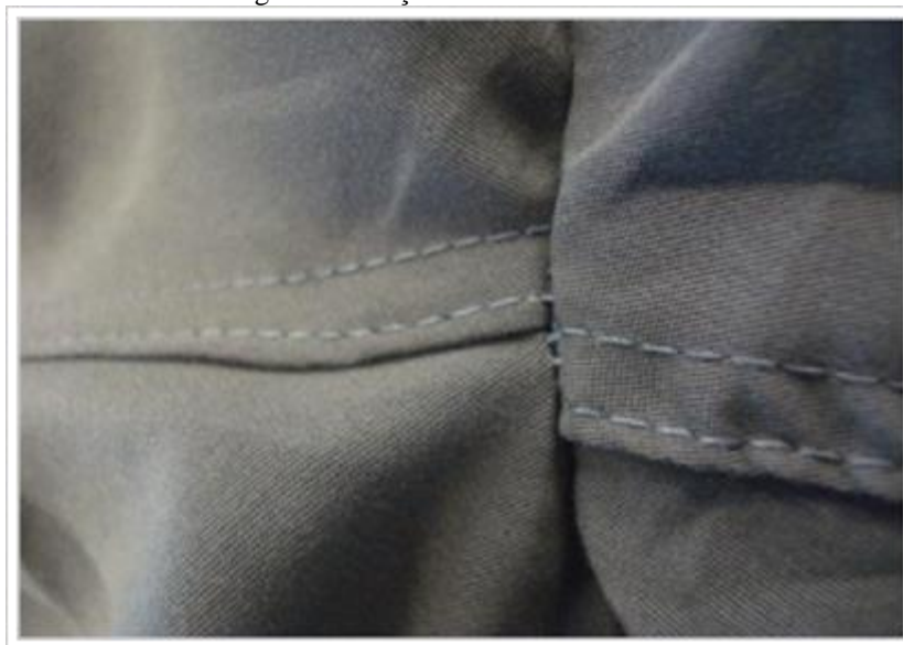
Figura 21 - Peça com costura descasada
