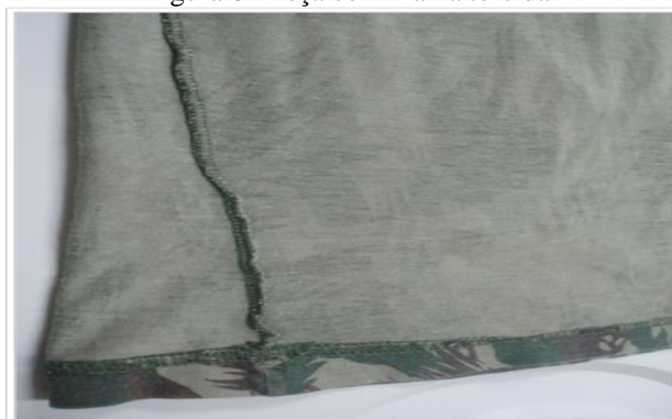
Figura 6 - Peça com malha torcida
