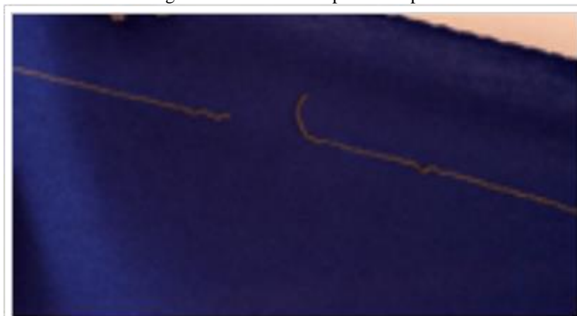
Figura 10 - Tecido com ponto rompido
