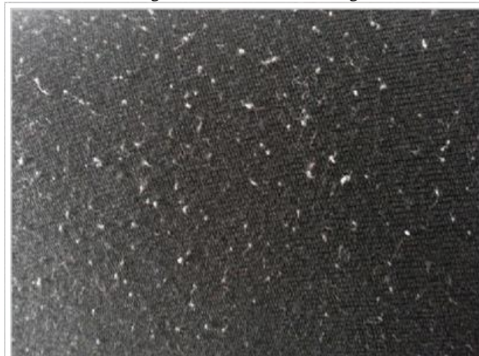
Figura 2 - Tecido com Pilling
