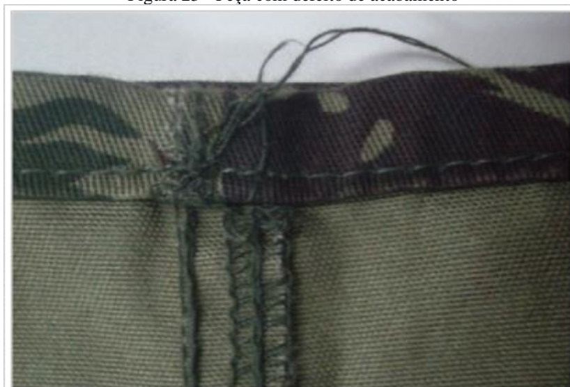
Figura 23 - Peça com defeito de acabamento
